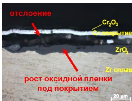
Рис. 7. Микроструктура образца Э110 + Cr (С) после испытаний в деаэрированной воде при 360 °С и давлении 18,6 МПа
